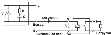
Возникновение паразитных сигналов: Вариант 1: управление - выходная плата переменного тока
